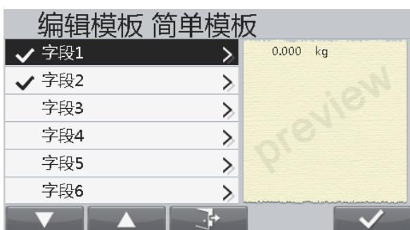
选择字段号（1至50），编辑模板格式。选择字段后，显示相应编辑内容。
