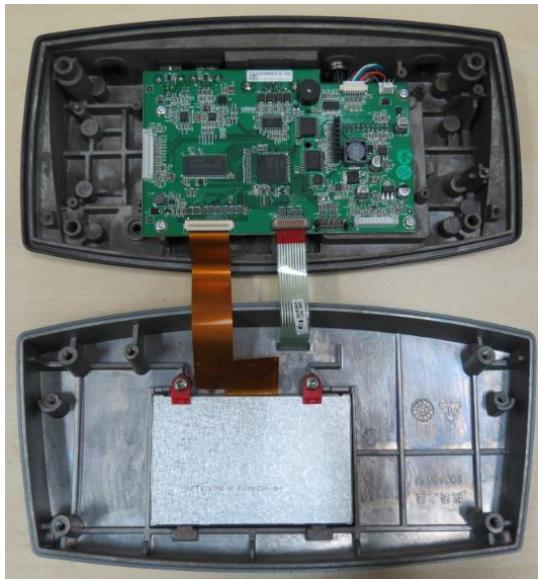
第 2 步. 如下图所示，将 Alibi 存储板插入卡槽；确保存储板的管脚和塑料支撑脚都正确插入。
