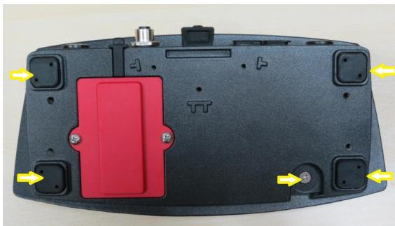
这四颗螺丝用于连接底部外壳和顶部外壳。取出螺丝后，将仪表翻转过来。然后，小心拿起顶部外壳，切勿将顶部外壳完全从底部外壳分离，这是因为仪表键盘的带状线缆和 TFT 显示屏的带状线缆仍然与仪表主板相连。
