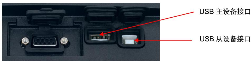
奥豪斯 USB 接口是使用通用串行总线 (USB) 把电子秤连接到电脑上的独特解决方案。USB 设备的类别包括磁盘驱动器、数码相机和打印机等。电子秤没有规定专用 USB 设备类别，因此奥豪斯 USB 接口使用基于 RS232 串口标准的通用接口。
