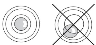
调节四角的水平调节指轮，直到气泡位于水平指示器中央。
